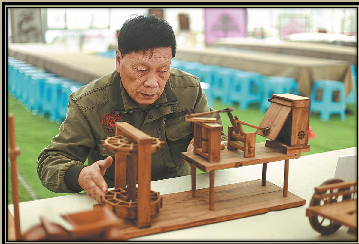
A Han-korabeli vízikerékkel működtetett kínai fűjtató rekonstrukciós modellje
