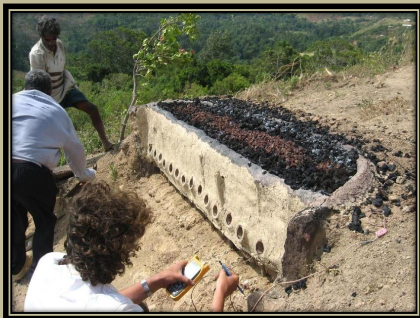
Szél által üzemeltetett olvasztó rekonstrukciója Srí-Lankán
